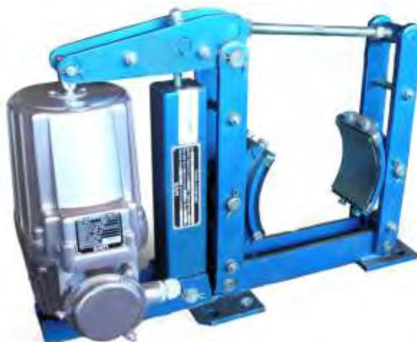
**Колодочные тормоза серии ТКГ** предназначены для остановки и удержания валов приводных механизмов в заторможенном состоянии при неработающем электродвигателе. В основном применяются в механизмах подъемно-транспортных машин: механизмах подъема и передвижения, но также могут использоваться в оборудовании с аналогичными условиями эксплуатации.
